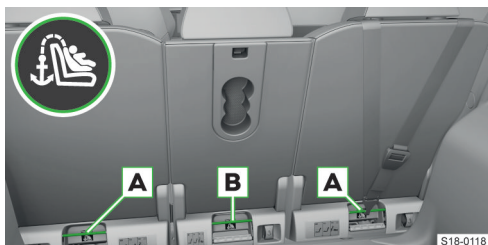
VarioFlex артқы орындықтарындағы бекіту құлақшалары
